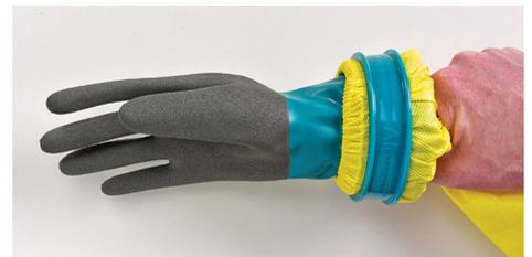
**Schritt 6** - Ärmel des Overalls wie oben abgebildet festhalten und darauf achten, dass die Faltenbildung am Ärmelende möglichst gering ist. Dann die grüne AlphaTec®-Manschette so den Ärmel hochschieben, dass das Ärmelbündchen freiliegt und die Manschette immer fester auf dem inneren Handschuhkonus sitzt.
